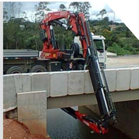
tão trabalhando nas inspeções. Com o controle remoto sem fio é possível ter o alcance médio de até 50 metros. Segundo o gerente operacional da Cunzolo, Robson Sanches, “outro destaque da operação é que a lança hidráulica secundária, JIB, articula abaixo da ponte até seis metros do nível da ponte e até seis metros da face para o centro da ponte, fazendo com que a mesma fique totalmente abaixo
